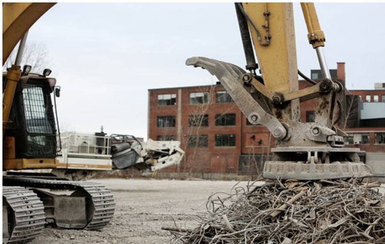
Electroimán para recogida de hierros
